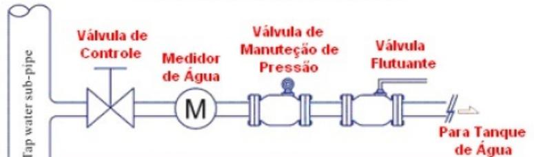
A válvula de manutenção de pressão é utilizada na instalação de tubulações para os usuários. Ela combina principalmente com a mínima pressão de funcionamento dentro do tubo, equilibrando a pressão, inclusive em caso de emergência, mantendo a pressão constante dentro do tubo.
